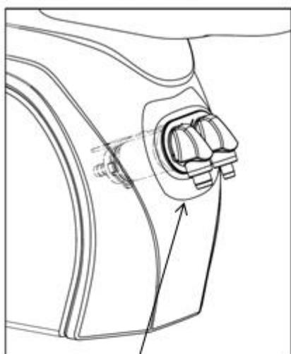
Фильтр твердых частиц мощного и слабого отсасывателя
