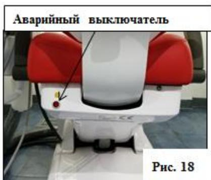
При нажатии на аварийный выключатель кресло перестает двигаться. Во время движения кресла вверх в течение 2 сек. аварийный выключатель находится в рабочем состоянии все время. Если кресло движется вверх в течение всего предусмотренного на это времени (однако, не превышая временной лимит, заложенный в настройках) и затем останавливается, изначальные настройки движения не сохраняются.
