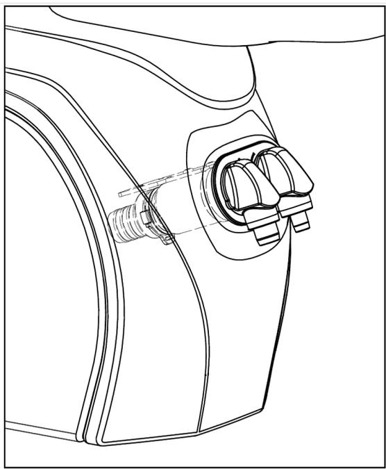
**Примечание:** Внешний вид подключенного к центральной системе аспирации фильтра твердых частиц (см. Рис. 14).
